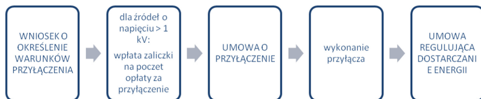
Rysunek 1. Proces przyłączenia instalacji OZE do sieci – podstawowe etapy
